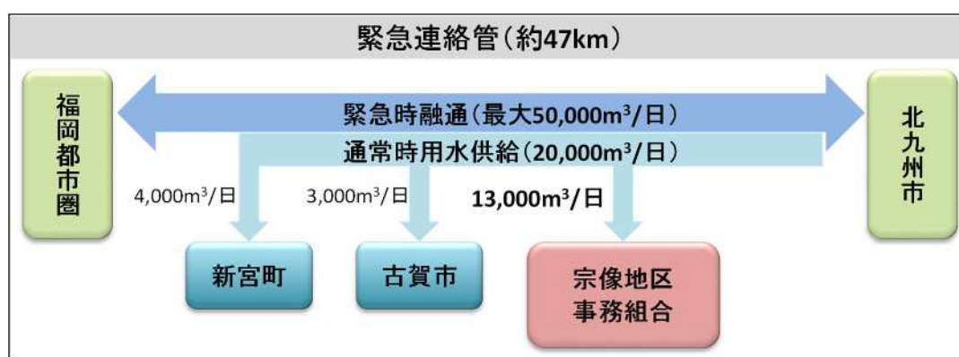
図 3-2 北部福岡緊急連絡管の水の流れ
